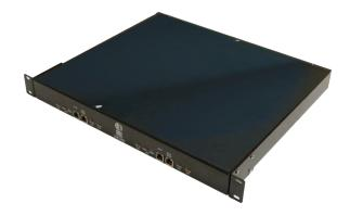
El UNC-500-FT-4R-RM es un controlador de 28 puertas desarrollado para ambientes empresariales de TI. Totalmente compatible con la galardonada solución integral de control de acceso Axiom sin depender del servidor, utiliza 1U de espacio en un rack estándar de 19 pulgadas, este PCA de alta densidad a prueba de fallas de red incorporando además componentes de ahorro energético con una reducción de más del 20% del consumo total de energía.
