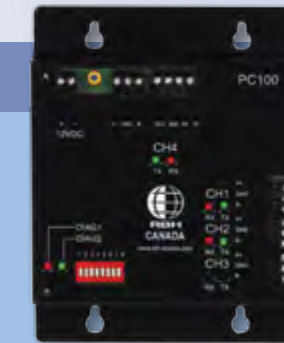
PC-100...Module Interface direct pour panneau d'alarme
