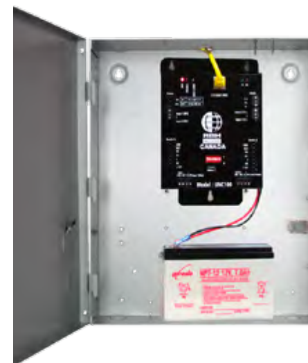
UNC-100-132... Montré avec Boîtier et batterie de secours
