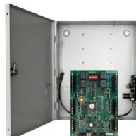
El controlador NIRC-2000-B está diseñado para su montaje en gabinete ENCL-1-PS. Los LEDs y el banco de interruptores DIP están montados en la parte frontal de la placa del controlador.
