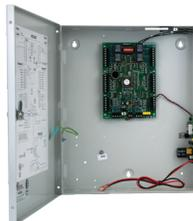
NIRC-2000-UL incluye un Controlador NIRC-2000-B instalado en gabinete ENCL-1-PS con interruptor tamper
